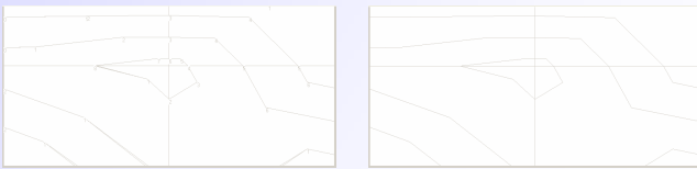
Figura 1 - Curva de nível com distância de 15 metros, mostrando os pontos à esquerda e não mostrando à direita.
