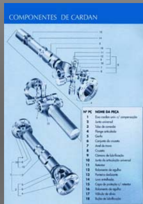
Fig. 1 - Eixo cardan de um caminhão mostrando seus componentes
