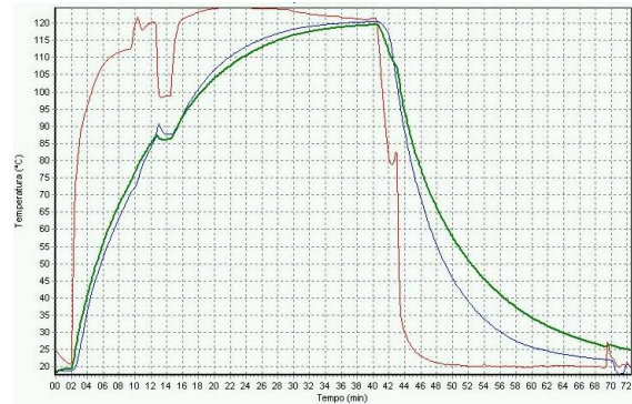
Figura 3. Evolução da temperatura do centro geométrico do enlatado versus simulação computacional com 25 elementos de volume
